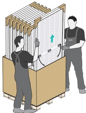
Sobald die Folie der Modulverpackung entfernt wurde, müssen die Module entnommen und gegen ein Kippen gesichert werden.
